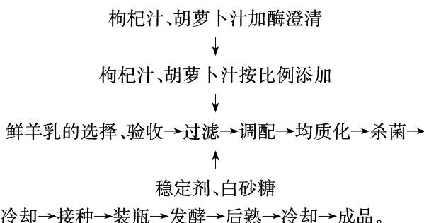
**操作要点:**选择酸度<18°T,蛋白质>2.8%,脂肪>2.9%,无抗生素、无任何杂质、气味纯正的鲜羊乳,将果胶酶澄清后的枸杞汁与胡萝卜汁按一定比例加入鲜羊乳中,并与稳定剂、白砂糖混合均匀,预热到 55~65℃,20 MPa 均质<sup>[15]</sup>,以改善口感及稳定性。后采用 92℃,15 min 巴氏杀菌,再迅速冷却至 40~45℃,将保加利亚乳杆菌和嗜热链球菌按 1:1 接入物料中,混和均匀后装瓶,置于 41~45℃培养箱中进行恒温培养发酵 3~4 h,刚好出现少量乳清时终止发酵,后自然冷却至 15~20℃,迅速转入 0~4℃冰箱中冷藏 12~24 h。
