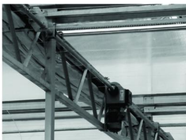
图2 内保温遮荫电机驱动传动机构
