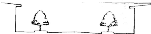
图3 一板二带式道路绿地断面图
