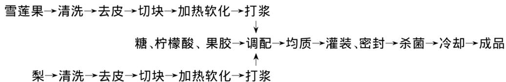
**1.2.2 操作要点** 雪莲果原果汁的制备: 将新鲜的雪莲果用流动清水清洗干净, 去皮, 将雪莲果切块并投入沸水中热烫 2 min, 捞出, 投入打浆机同时加入 0.20% 的维生素 C 和 0.15% 的亚硫酸钠进行打浆, 放入贮料罐中备用。梨原果汁的制备: 制法与雪莲果原果汁制法基本一致。调配、均质: 将处理后的雪莲果原汁、梨原汁、果胶、糖和柠檬酸等按一定比例装入调配罐混合均匀。混合汁需要均质处理, 其目的是使果汁中的果肉颗粒进一步破碎细化, 大小更为均匀, 同时促进 2 种水果原料和其它辅料均匀一致, 形成均一稳定的分散体系。用 20~25 MPa 的压力进行 2 次均质。灌装、密封、杀菌: 均质好的雪莲果复合汁装入 250 mL 的玻璃瓶中, 密封后于 95~100℃ 杀菌 15 min, 冷却后即成品。
