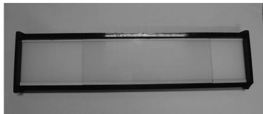
图4 BIORAD-3 000XI 电泳设备的制胶板(中间放的是玻璃)
